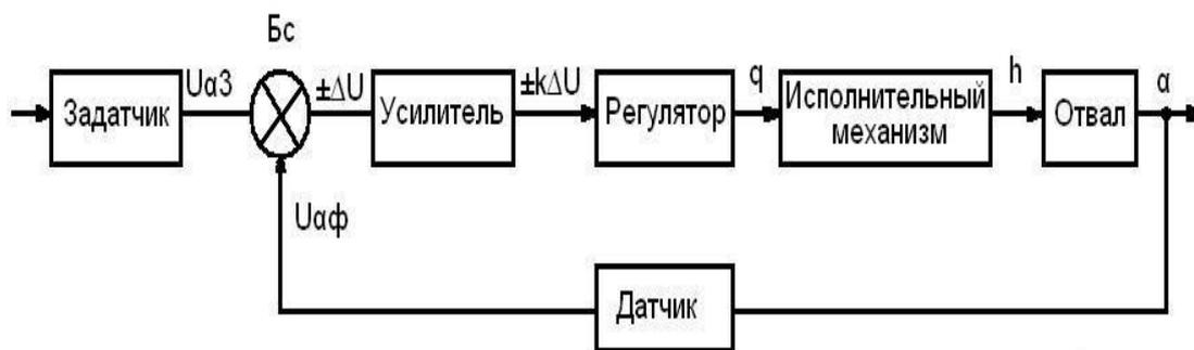
Рисунок 1.2 - Структурная схема САР «Профиль-1»
