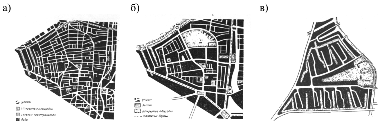
Рис. 1.10. Район Шордич у Лондоні до руйнування (а), офіційно затверджений проект відновлення цього району (б) і варіант планування району за органічним принципом побудови ВДМ (в)
