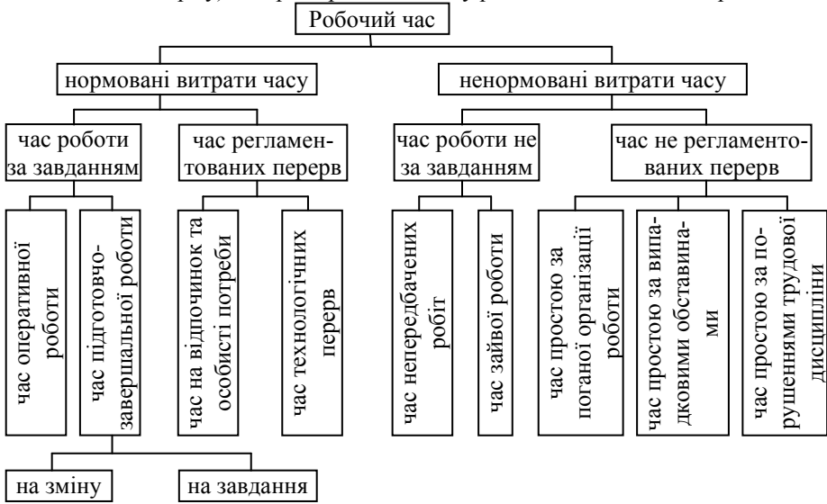
Рисунок 3.1 Схема аналізу робочого часу для цілей технічного нормування
