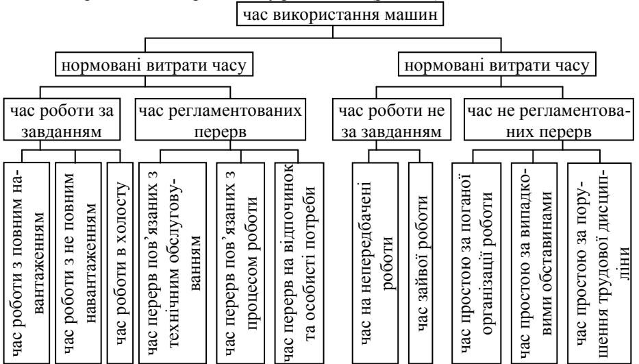
Рисунок 3.2 Схема аналізу часу використання будівельних машин для цілей технічного нормування
