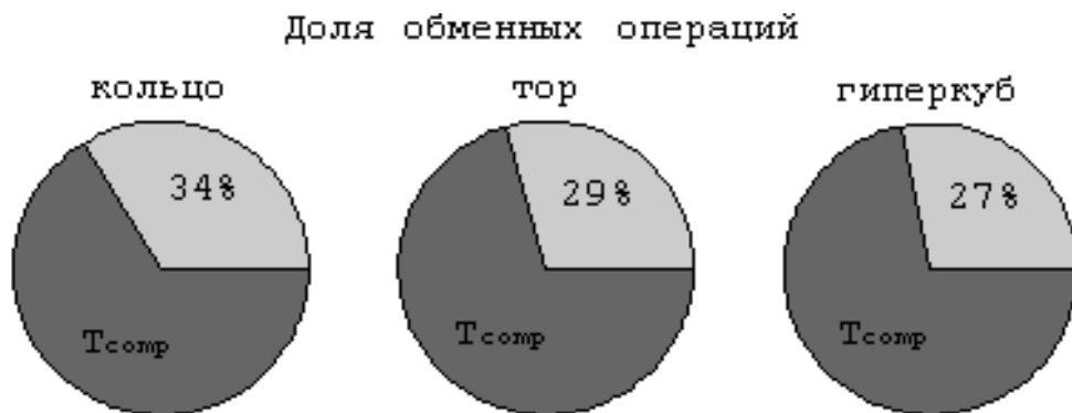
Рисунок 3.4 – Доля обменов к общему времени выполнения блочного метода с правилом Рунге для различных топологий
