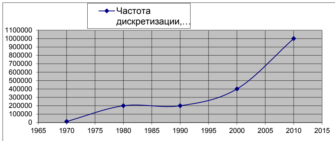
Рисунок 3 – Рост скорости преобразования (частоты дискретизации) АЦП и ЦАП с 1970 по 2010 гг.
