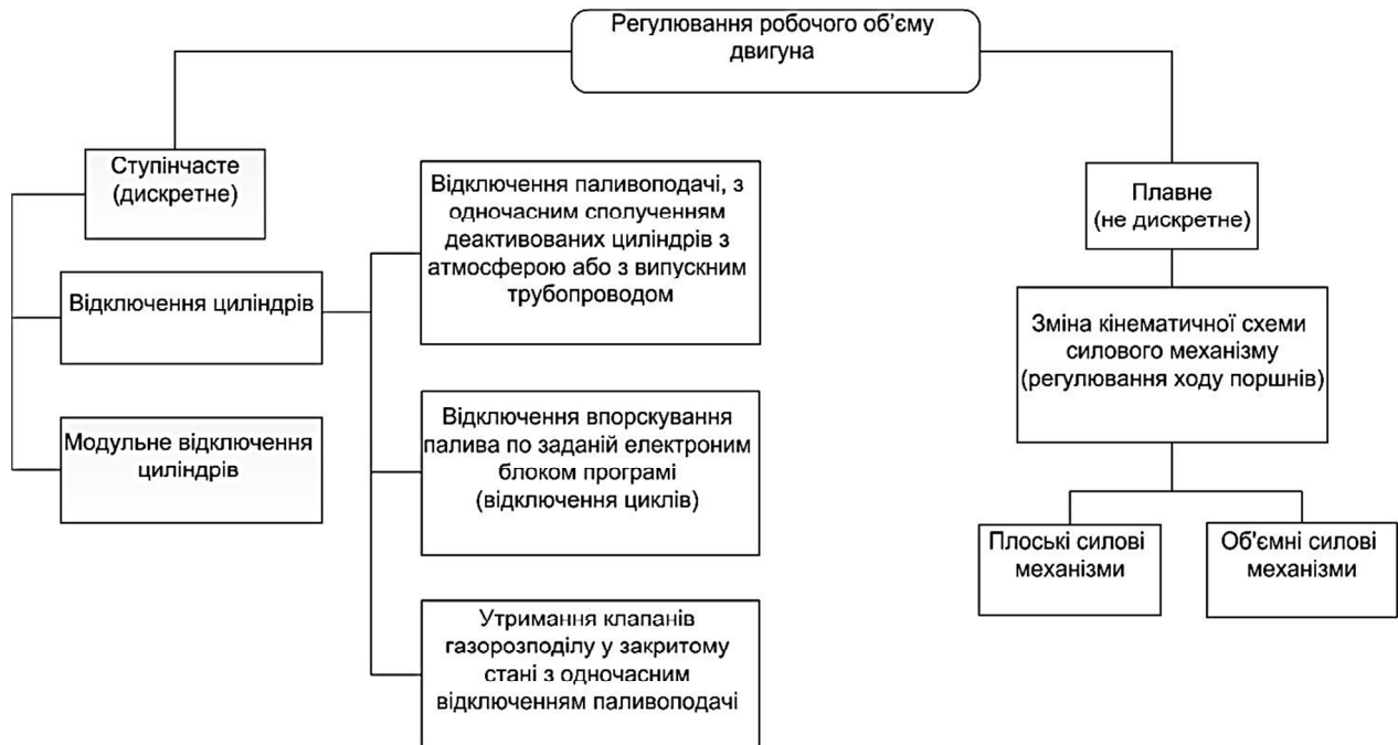
Рисунок 1 – Схема регулювання робочого об'єму ДВЗ
