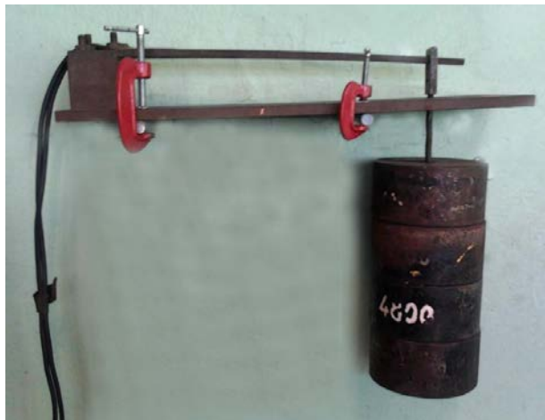
Рисунок 2 – Статическое нагружение тензометрической балочки
