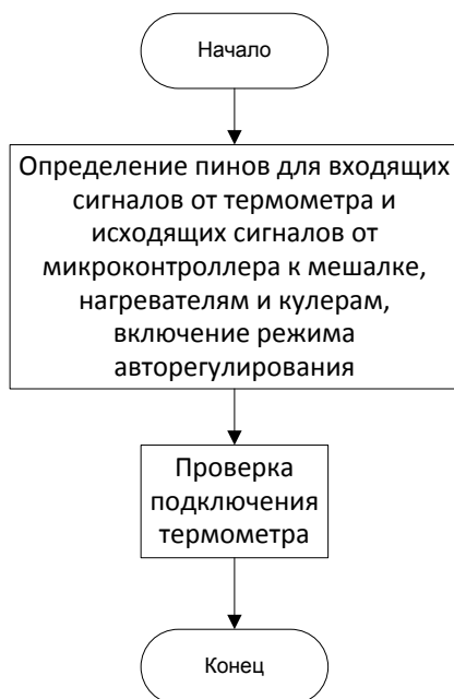
Рисунок 1 - Действия, выполняемые единожды при включении микроконтроллера
