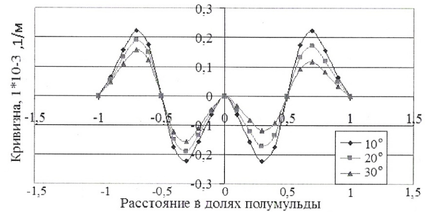
Рис. 4. График кривизны земной поверхности при разных углах залегания угольного пласта для второго примера
