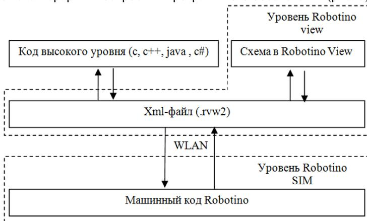
Рисунок 3 – Иерархия построения ПО для Robotino
