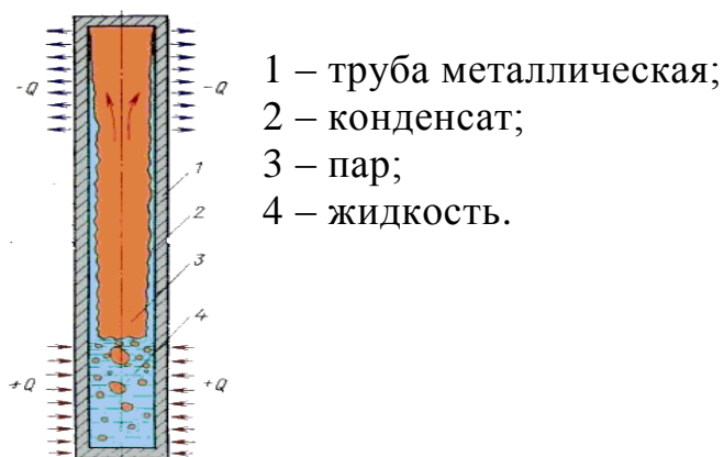
Рисунок – Схема термосифона
