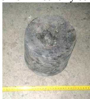
Рисунок 2 Внешний вид слитка ЭКЛ
