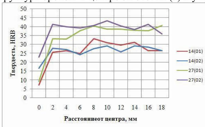
Рисунок 2 – Изменение твердости бронзы БрОЦС по сечению заготовки
