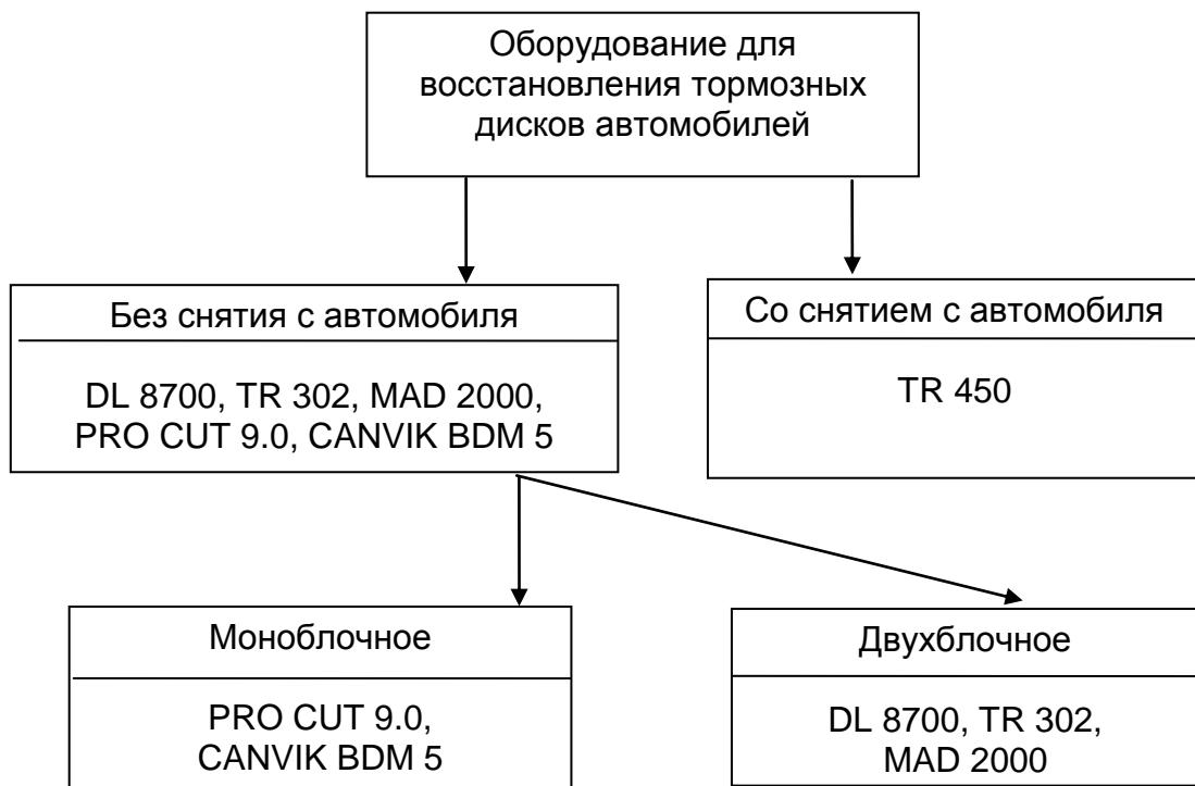
Рис. 1. - Оборудование для восстановления тормозных дисков автомобилей
