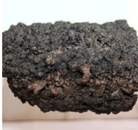
Рис. 7. Коксовые остатки интумесцентных композиций: 1 – ПФА / ПЭ / МА / ЭВА, 2 – ПФА / ПЭ / МА / ЭВА / I
