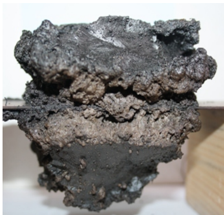
Рис. 7. Коксовые остатки интумесцентных композиций: 1 – ПФА / ПЭ / МА / ЭВА, 2 – ПФА / ПЭ / МА / ЭВА / I
