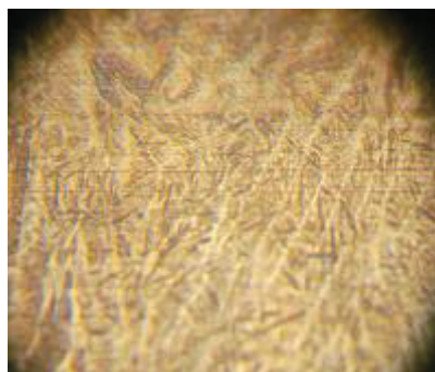
Рисунок 1 - Микроструктура поверхностного слоя с оплавлением ( \times 400 )
