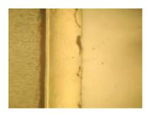
Рисунок — нетравлёная микроструктура зоны контакта твердосплавной пластины с подложками и основным металлом.
