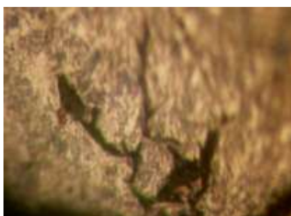
Рисунок – Микроструктура заготовки в области дефекта при увеличении \times 200
