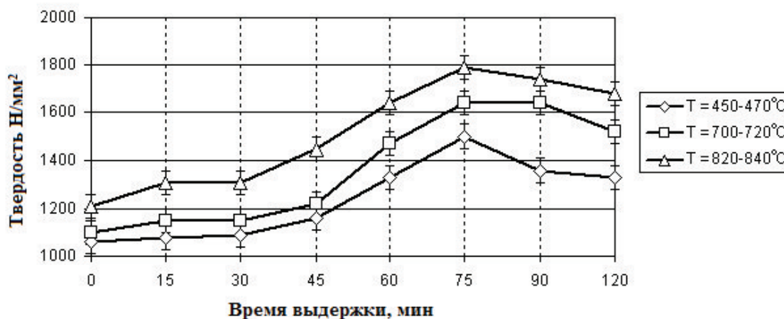
Рисунок 1 – Зависимость твердости латуни Л63 проведения закалки от разных температур (Т) от длительности выдержки на протяжении старения при 230-250 °С
