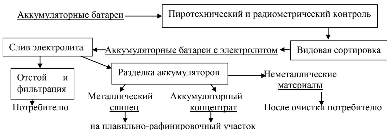
Рисунок – Технологическая схема участка подготовки лома аккумуляторов
