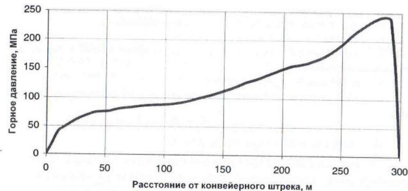
Рис. 1. Распределение горного давления по длине забоя при сплошной системе разработки во 2-й лаве центрального бремсберга пласта l_1 .
