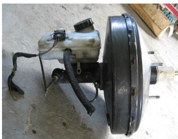
Рис. 2. Гальмівний циліндр автомобіля
