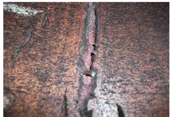
Рисунок 12. Тріщина на поверхні зливка, що розкрилася під час прокатки
