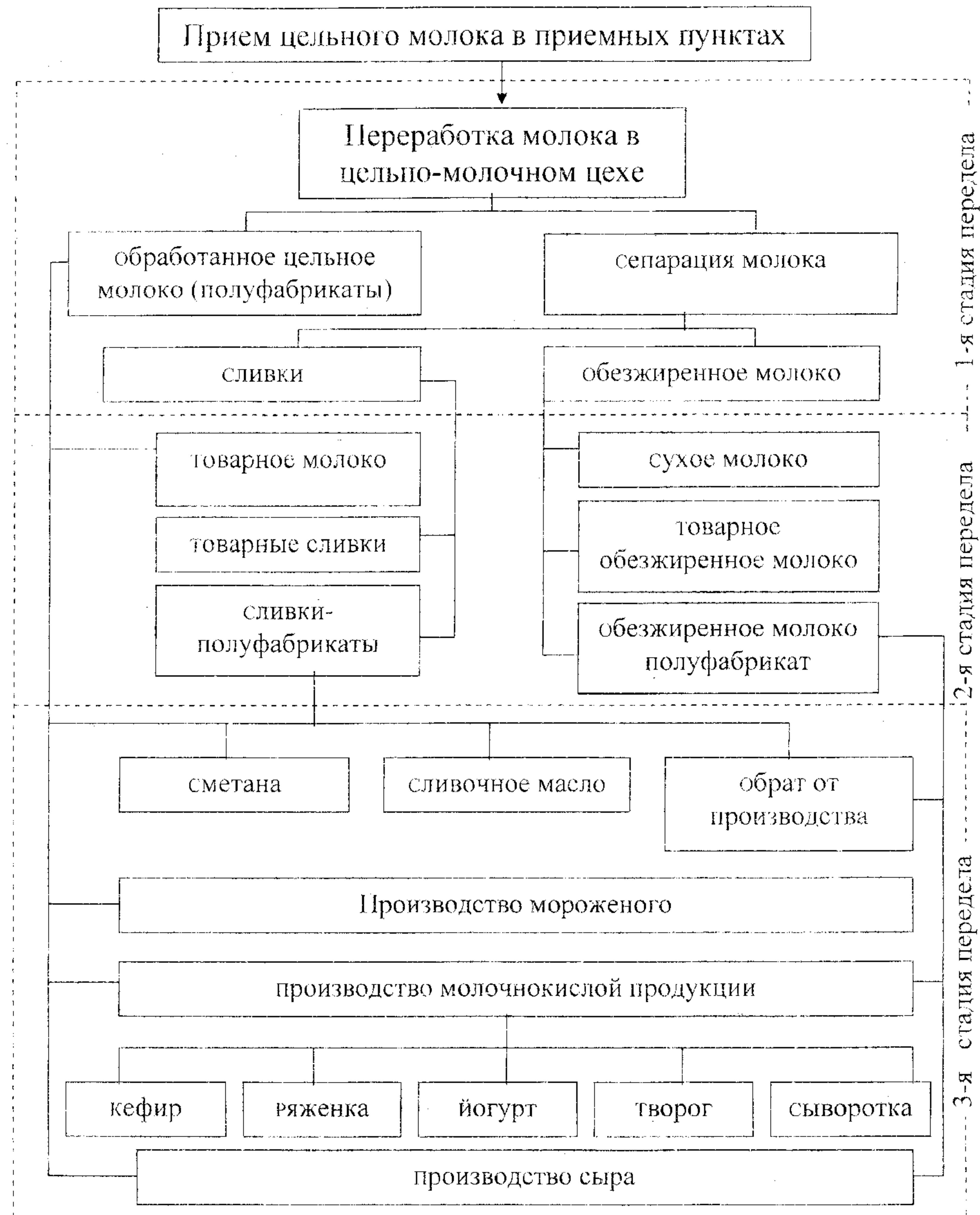
Рис. 5.3. Схема попередельного метода выпуска молочной продукции
