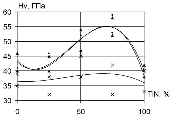
Рис. 1. Зависимость микротвердости от процентного состава TiN в покрытии  $TiB_2+TiN$  (размер кристаллов 3-10,2 нм) [15]: экспериментальные значения при  $\blacktriangle$  –  $E_i=350$  эВ,  $\bullet$  –  $E_i=500$  эВ,  $\times$  –  $E_i=110$  эВ
