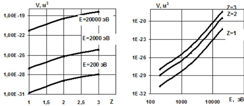
Рис. 8. Зависимость объема наноструктур от заряда и энергии ионов: Mo; Hf, Ta, W, Pt
