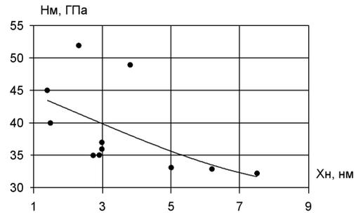
Рис. 2. Микротвердость покрытия в зависимости от размера кристалла [16]: экспериментальные значения при  $\bullet$  –  $E_i=250$  эВ
