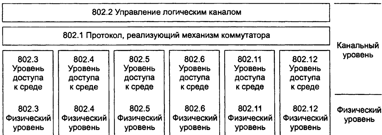
Рисунок 15.8. Место протокола коммутатора в стеке протоколов
