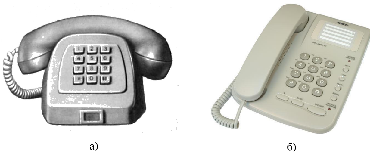
Рисунок 1.5 – Тастатурний телефонний апарат: а) електромеханічний; б) електронний
