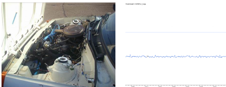
Рисунок 4 – Розміщення на автомобілі датчиків повороту керованих коліс та зразок осцилограми кута повороту керованих коліс
