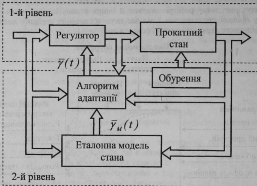
Рисунок 2 – Двохрівнева структура адаптивного управління
