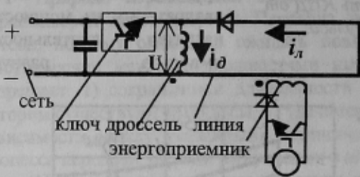
Рисунок 8 - Схема создания импульсов тока в линии
