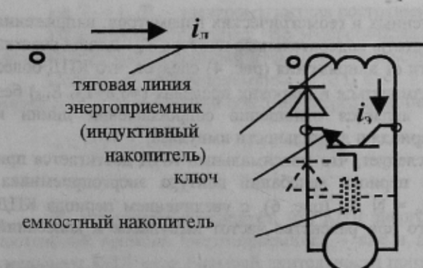
Рисунок 2 - Схема энергоприемника с накопителем
