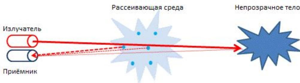
Рисунок 1 - Принцип действия светодиодного и лазерного дальномера
