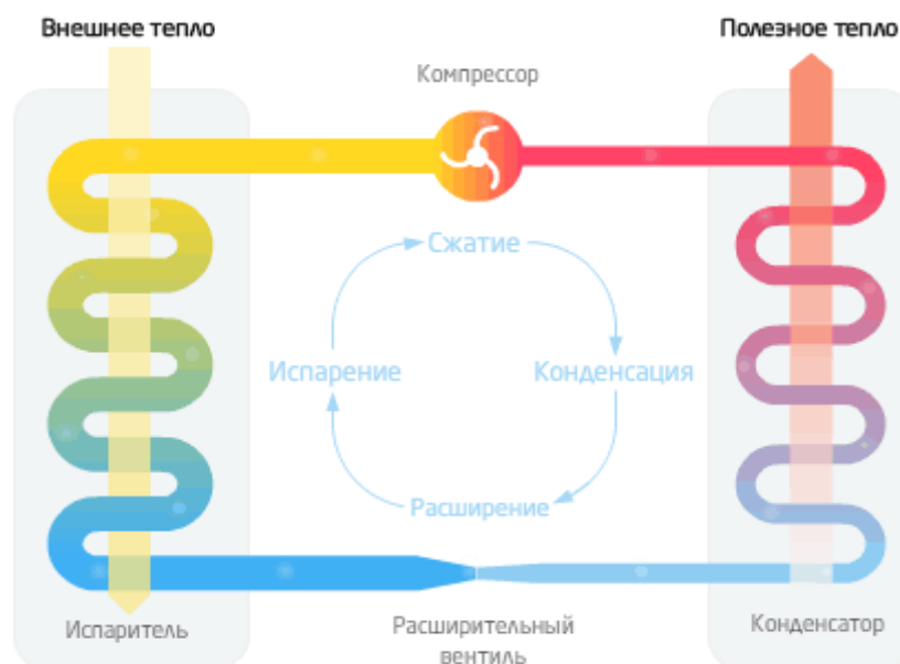
Рисунок 1 - Общая схема работы теплового насоса
