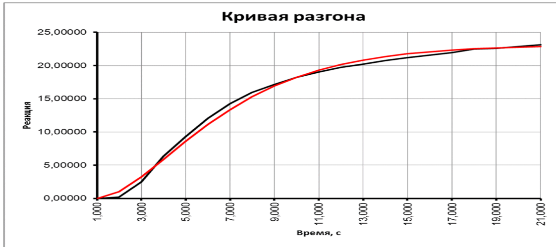
Рисунок 5 - Реальная и теоретическая кривая разгона (для модели 2го порядка)
