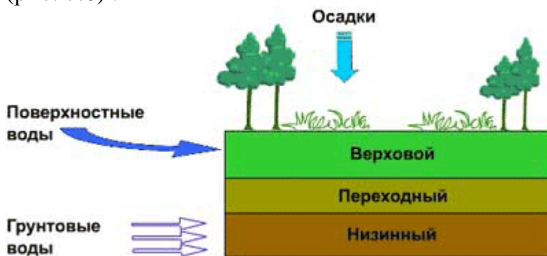
Рис. 7.6 - Принцип утворення торф'яного покладу
