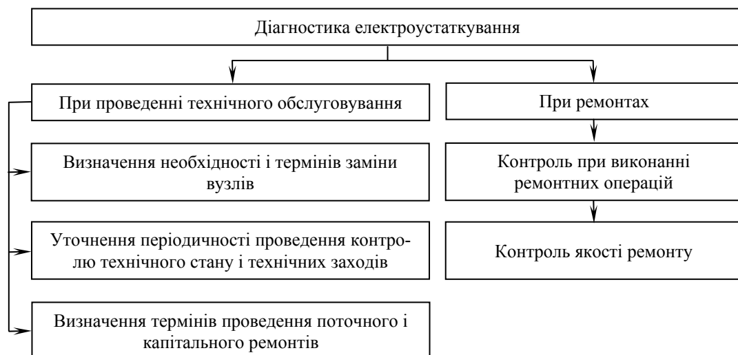
Рисунок 3 - Область застосування технічних засобів діагностики при використанні ОФС
