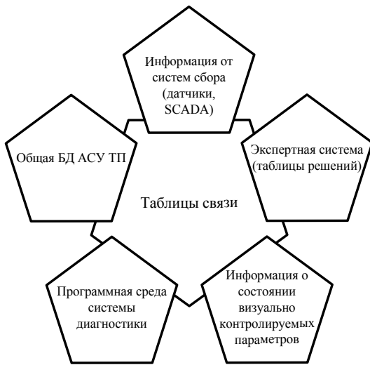
Рисунок 3 – Структура построения информационной составляющей системы диагностирования генераторов
