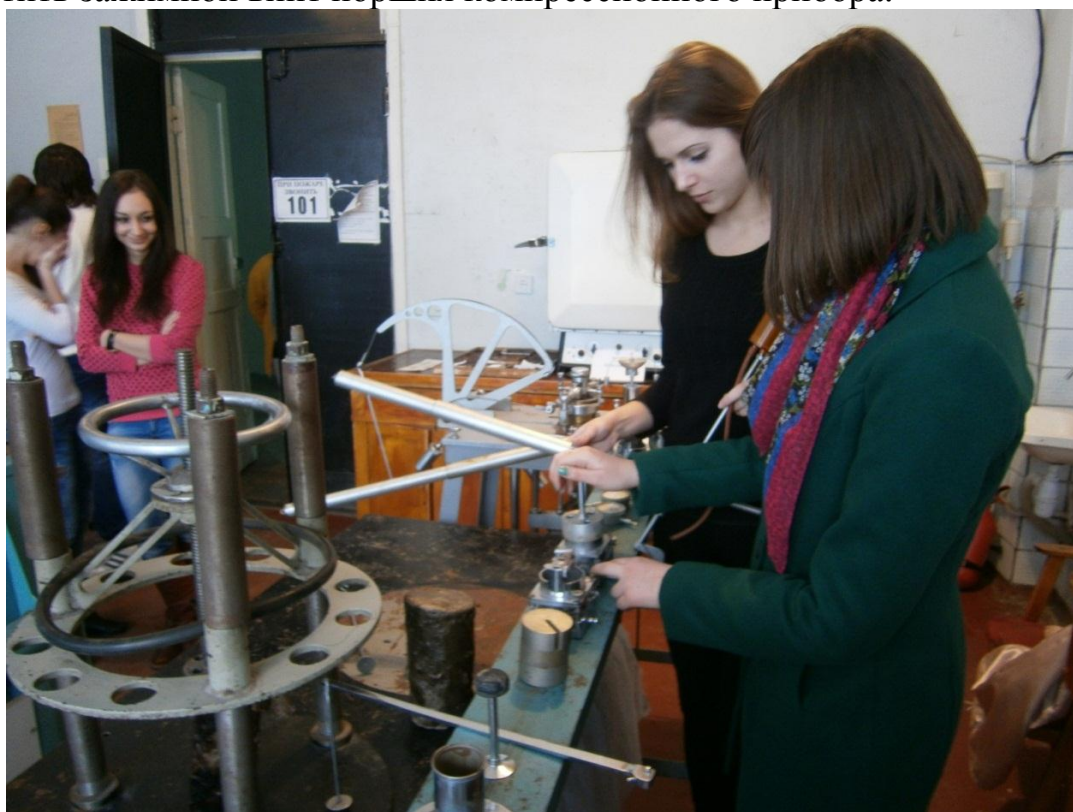
Рис. 15. С помощью выталкивателя переместить образец в компрессионный прибор
