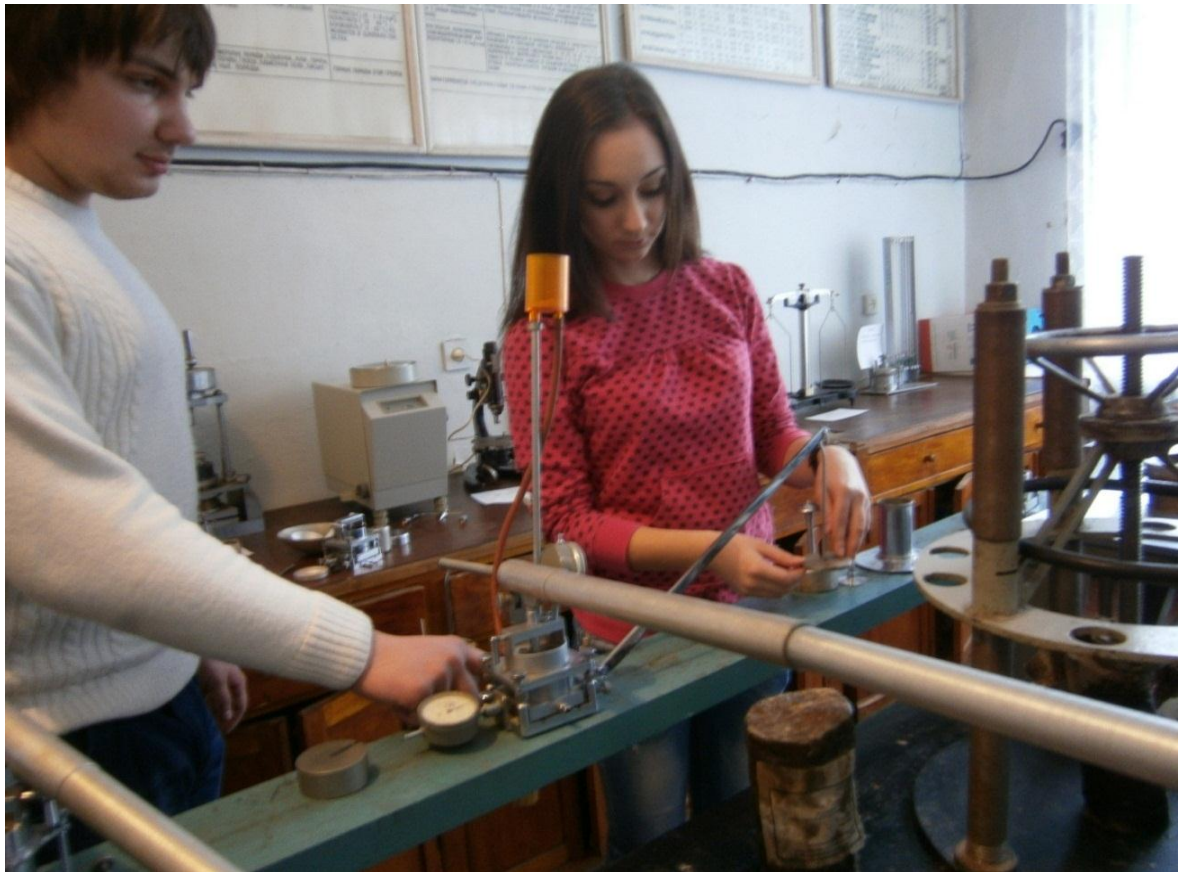
Рис.19. Горизонтальное сдвигающее усилие прикладывают ступенями по 10 кПа
