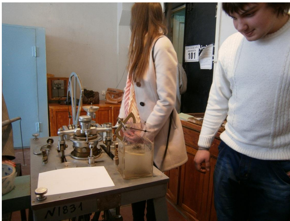
Рис.12. Определение скорости размокания грунта прибором ПРГ-1
