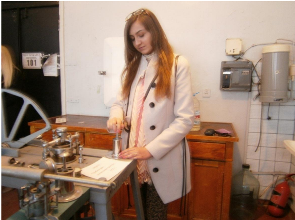
Рис.3 Отбор образца с помощью грунтоотборника ПЛЛ
