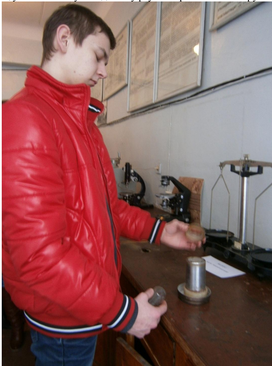
Рис. 7. Установка верхней муфты на трубку
