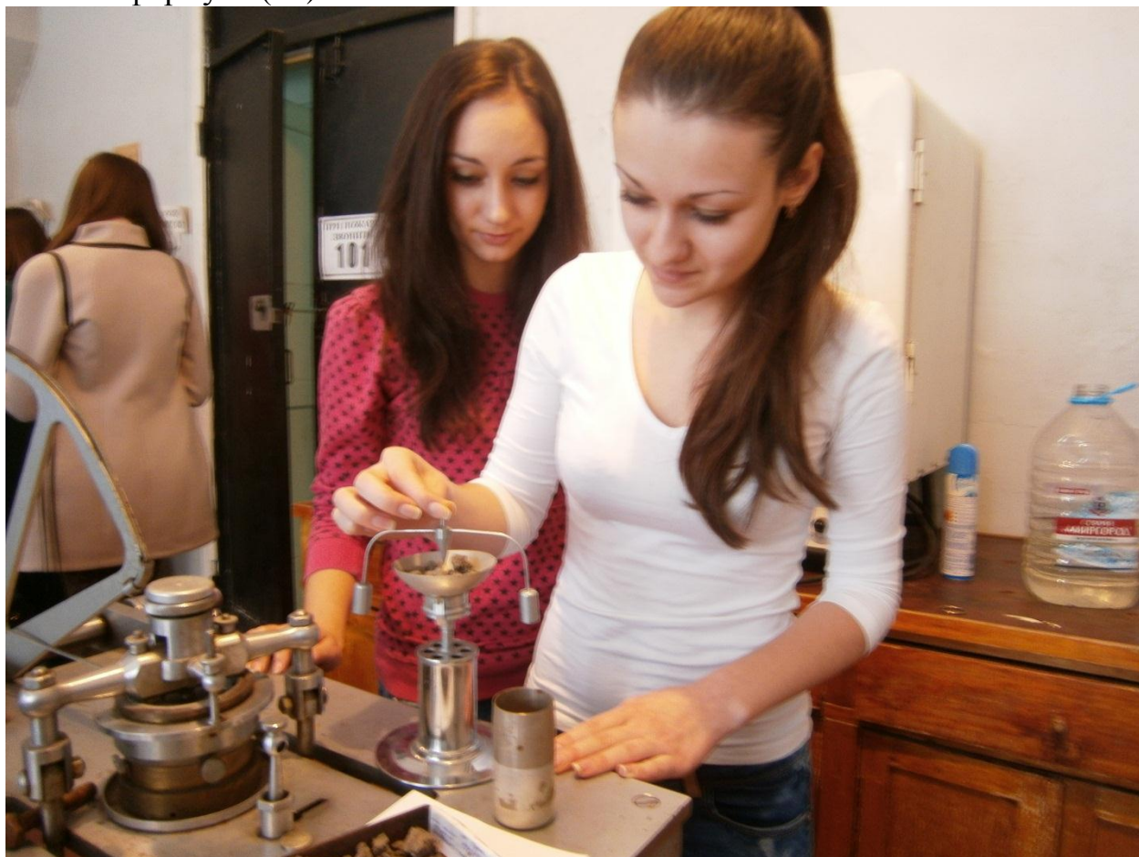
Рис.10. Определение верхнего предела пластичности с помощью балансирующего конуса КБВ
