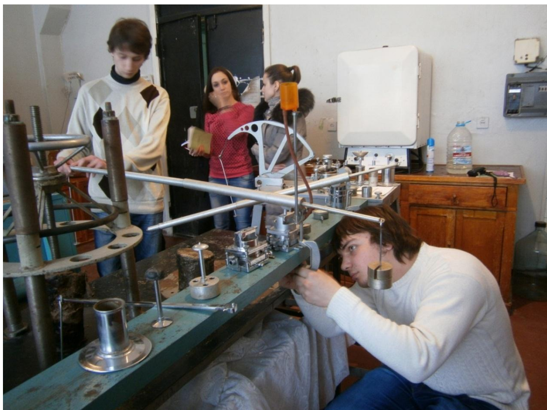
Рис.19 Укрепление сдвигового прибора с помощью струбцины
