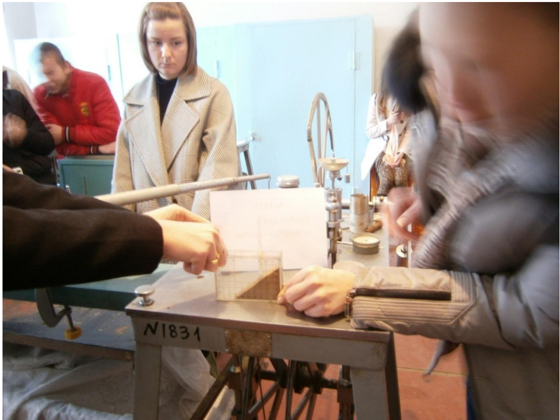
Рис. 23. Определение угла естественного откоса песчаных пород с помощью прибора УВТ
