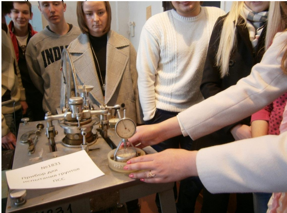
Рис.4. Внешний вид прибора для определения набухания грунтов ПНГ2
