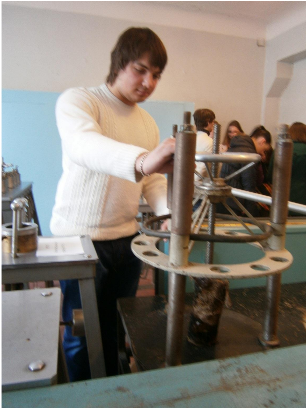
Рис.2. Отбор образца с помощью пробоотборника.
