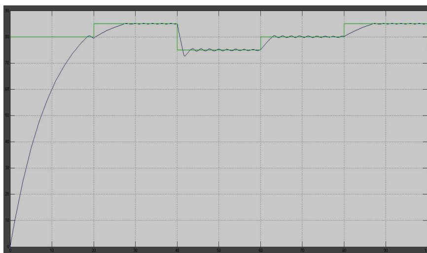
Рисунок 11 – Переходный процесс в САУ температурой нагревательного теплообменника
