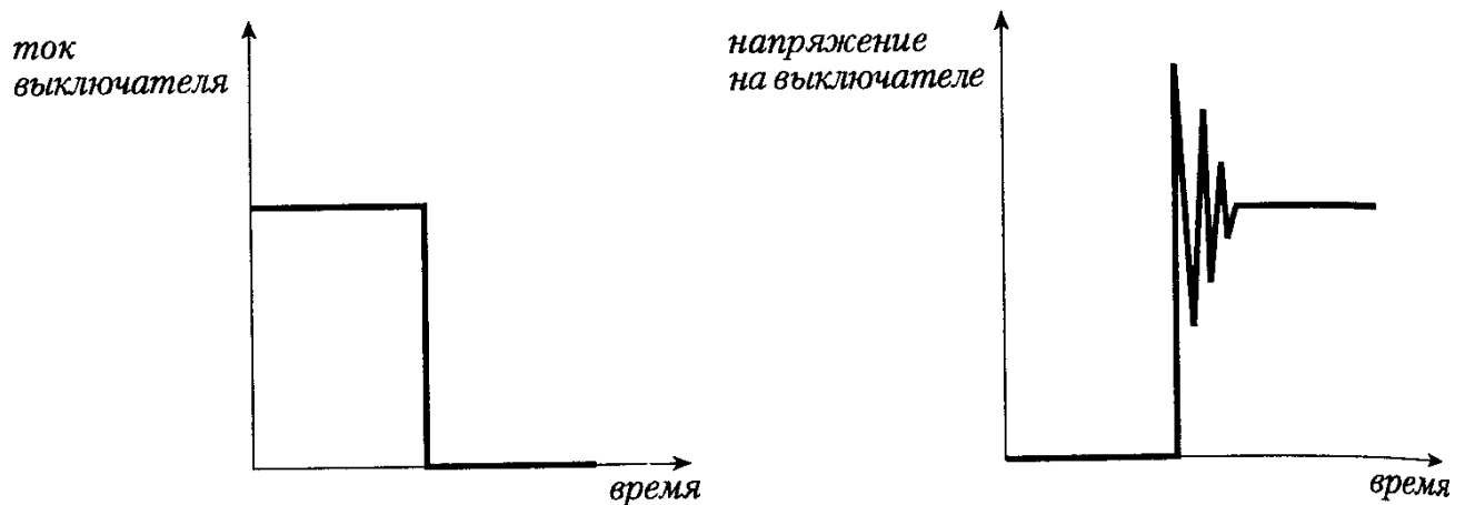
Рисунок 13.1. Броски напряжения, возникающие в индуктивном исполнительном механизме при размыкании выключателя
