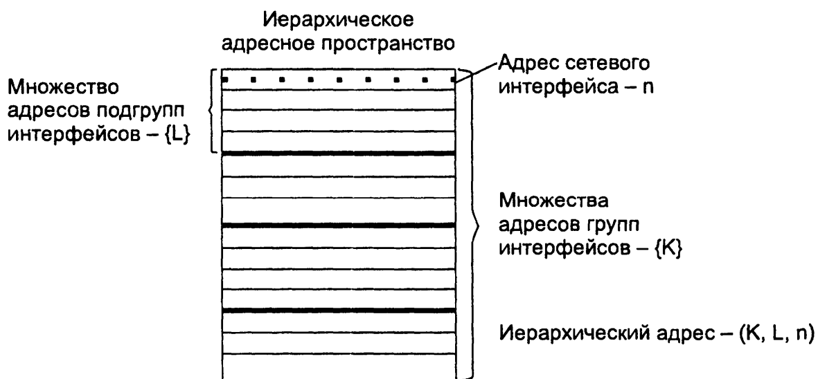
Рисунок. 4.2. Иерархическая организация адресного пространства
