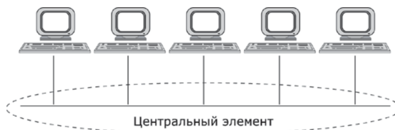
Рисунок 3.8. Топология "общая шина"
