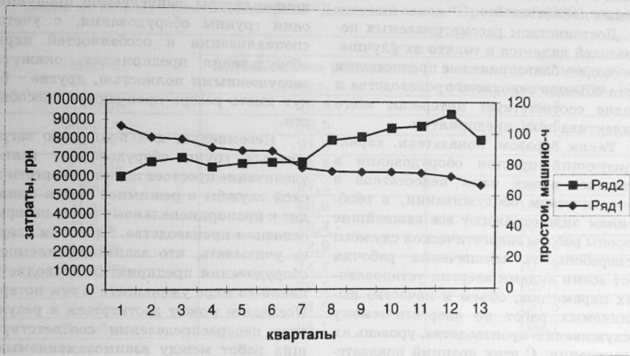
Рисунок. Динамика затрат на энергетическое обслуживание производства и простоев основного технологического оборудования
