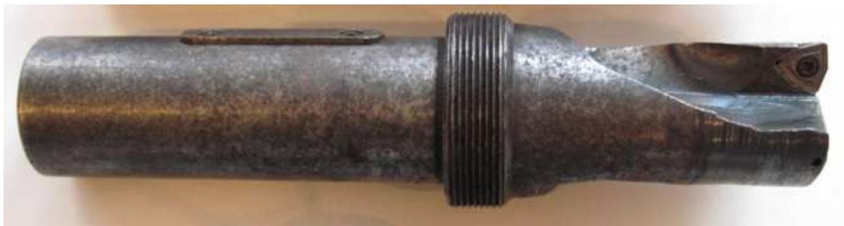
Рис. 1. Загальний вигляд збірного свердла з механічним кріпленням ЗБП
