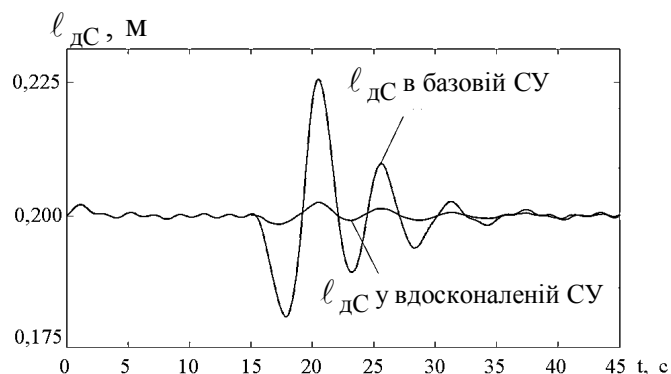
Рисунок 7 – Графіки зміни довжин дуг фази С при імітації збурення в базовій та вдосконаленій системах управління
