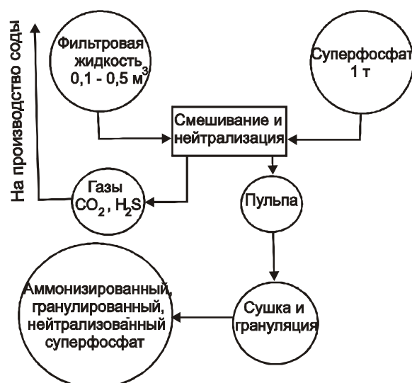
Рис. 1. Принципиальная технологическая схема переработки фильтровой жидкости содовых заводов в двойное азотно-фосфорное удобрение
