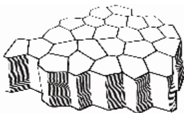
Рис.9. Схематическое представление зернистой структуры окалина при длительных временах окисления
