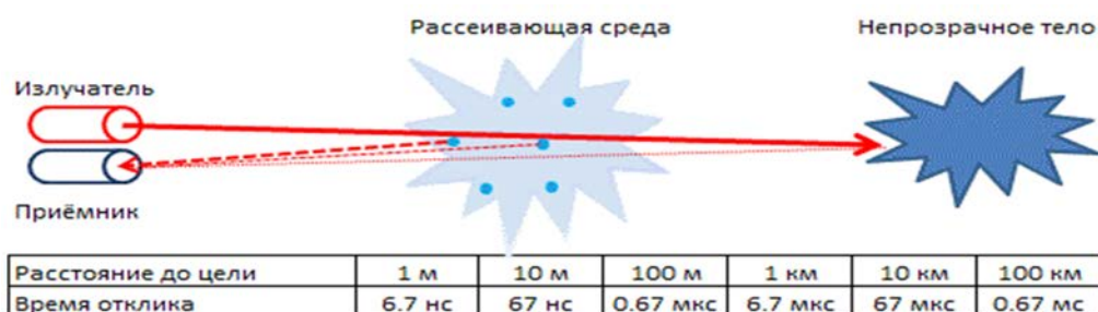
Рисунок 1 - Принцип действия светодиодного и лазерного дальномера
