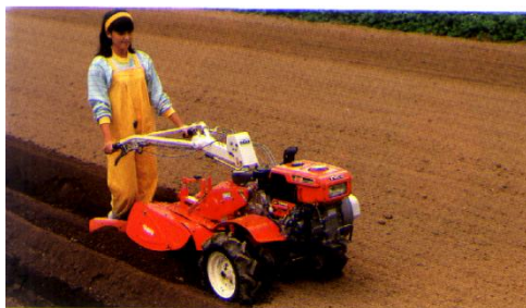
Рис. 1.8. Малогабаритные двухколесные тракторы с пешеходным управлением (мотоблоки) модели Т фирмы Kubota (Япония)
