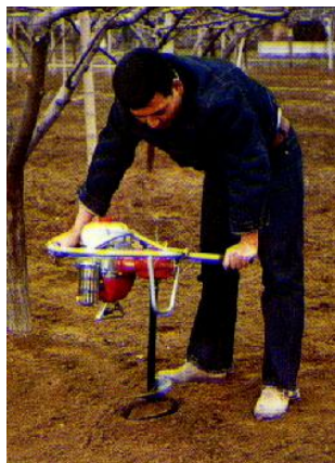
Рис. 1.5. Мотобур модели FAG 10 фирмы KOMATSU ZENOAH: мощность двигателя — 1,69 кВт; масса машины — 11,6 кг без бура (справа)
