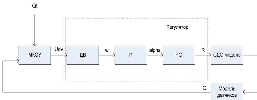
Рисунок 3 - Структура регулятора
