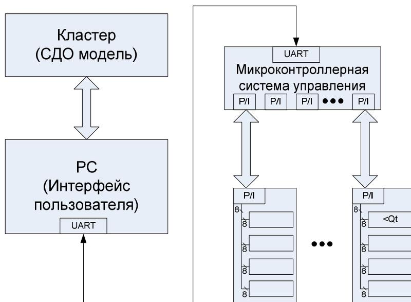
Рисунок 1 – Структура системы управления потоками воздуха
