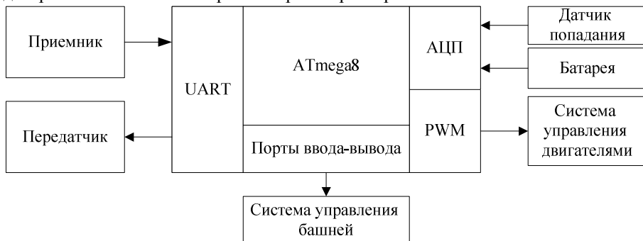
Рисунок 2. Структурная схема устройства управления танком
