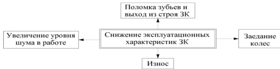
Рис. 2. Основные причины снижения эксплуатационных характеристик зубчатых колес
